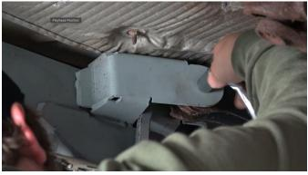
Reinstall upper sway bar end link bolt.
